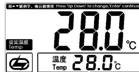
按“温度△”或“温度▽”键调节显示值，使温度显示为被测溶液的温度，按“确认”键，即完成当前温度的设置，按“pH/mV”键放弃设置，返回测量状态。
