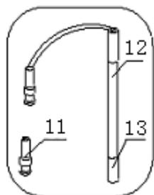
11——Q9 短路插 12—— E-201-C 型 PH 复合电极 13 ——电极保护套
